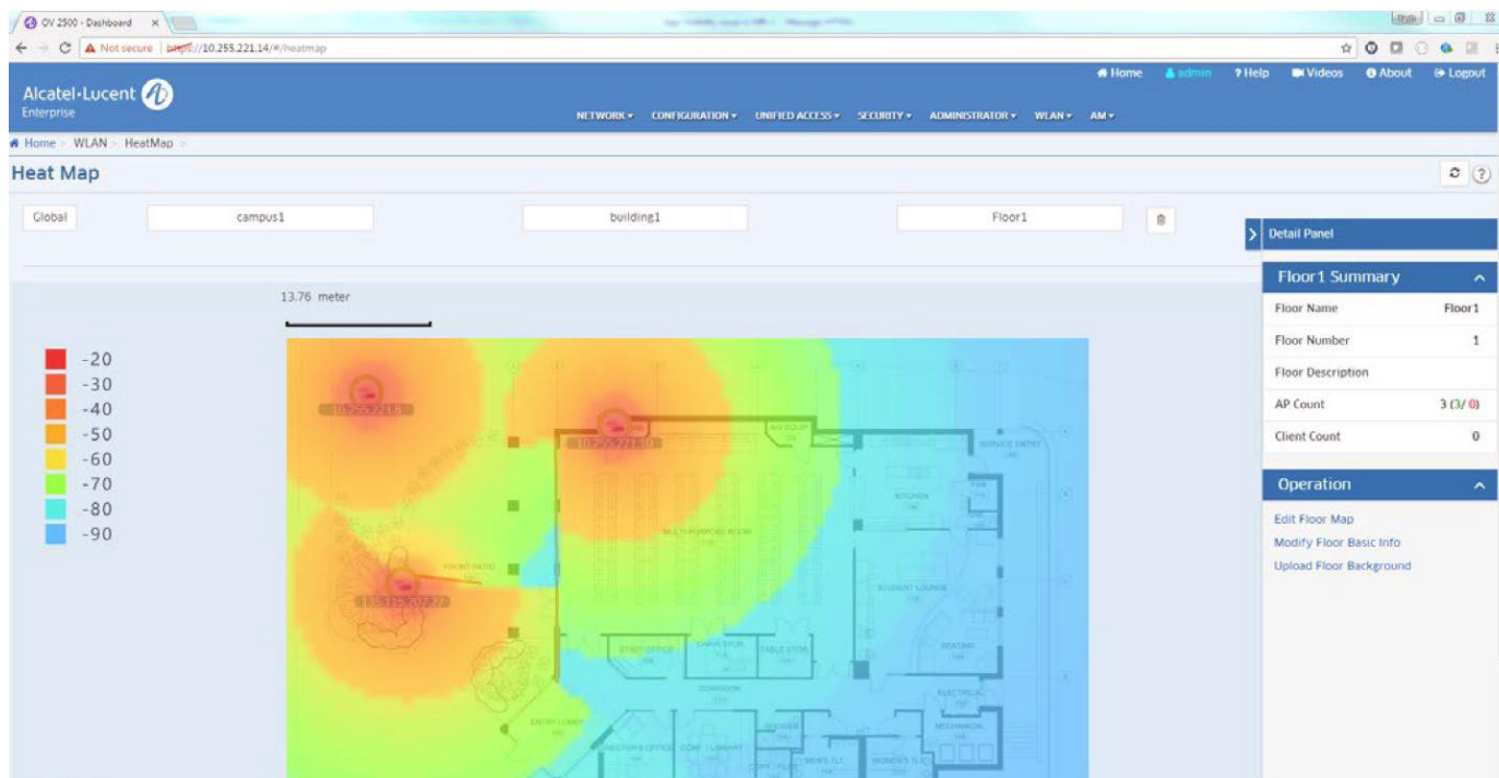
Рисунок 3. Тепловая карта для оптимизации покрытия Wi-Fi и производительности беспроводной сети
